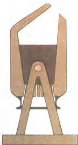
形状与大型混凝土搅拌机类似的贝塞麦转炉
